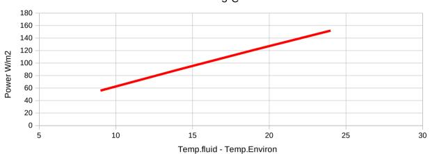
Mantenendo la stessa portata di fluido nel sistema, avremo una differenza di temperatura di raffreddamento di circa 2  $^{\circ}$  C (18  $^{\circ}$  C temp.ln).
