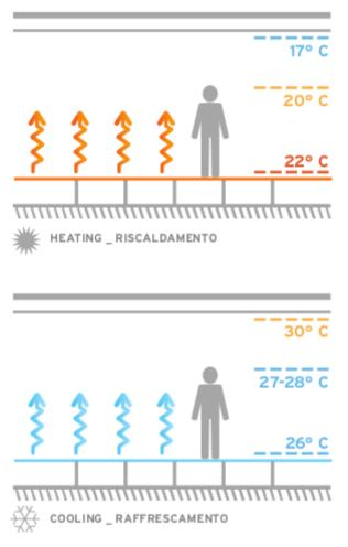
fluido Ш termovettore che scorre attraverso i pannelli fornisce riscaldamento radiante o raffreddamento senza movimenti di aria e assicura una grande uniformità della temperatura in tutto l'ambiente che di conseguenza, si traduce in un livello molto più elevato di benessere rispetto quello che può essere dai sistemi raggiunto convenzionali. La bassissima stratificazione del calore e la ridotta inerzia termica contribuiscono a ridurre i costi di gestione del sistema.
