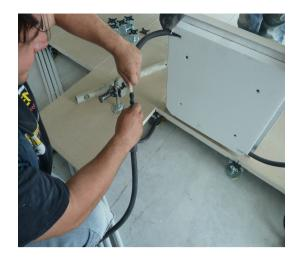
Facile assemblaggio delle serie di mattonelle tramite raccordi ad inserimento rapido
